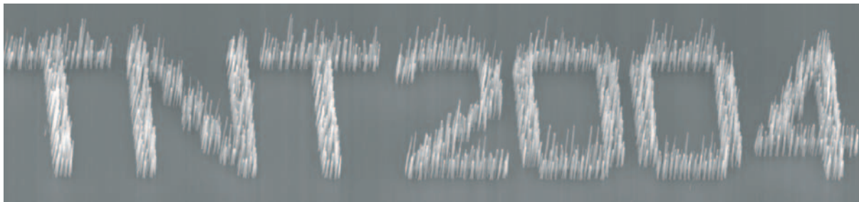
→ Figura 2: Nanotubos de carbono ordenados sobre una superficie mediante técnicas de litografía electrónica (Cortesía Ken Teo, Universidad de Cambridge). La imagen ilustra el logotipo oficial de la edición del año 2004 de la conferencia Trends in Nanotechnology, celebrada en Segovia.
